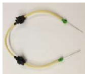
Conexiones cabezal 50 de 0,5 mm y 0,8 mm
