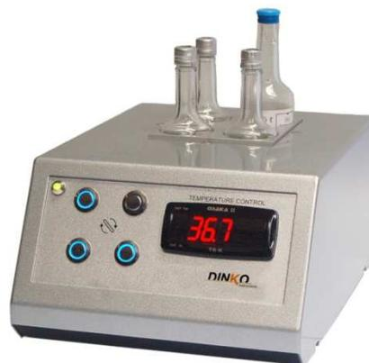
En el panel frontal se encuentra el indicador digital del controlador de temperatura tipo PID táctil con el que se puede programar la temperatura a mantener y los interruptores de la agitación para cada posición del bloque metálico.
