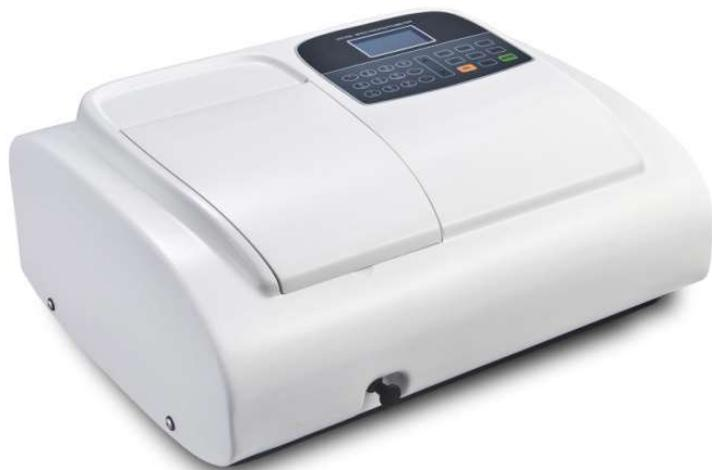
Un instrumento compacto diseñado para mediciones en el rango de 320 - 1100nm de forma rápida, sencilla y precisa.
