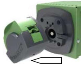
Ofrezca el nuevo cabezal a la placa posterior en un ángulo que ubique el eje del motor al rotor del eje dentro de la placa posterior en aproximadamente 45°, encarando las agarraderas en el alojamiento.
