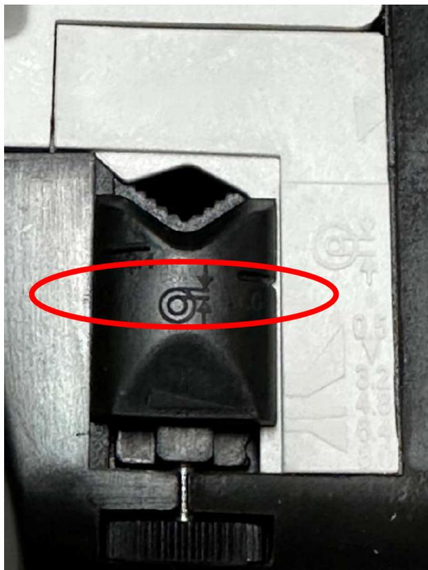
En rojo podemos ver la posición correcta de cómo tiene que quedar la marca de la parte móvil con el cabezal cerrado, comprobar, ejerciendo una pequeña presión, que la parte móvil está situada en la posición más inferior posible.
