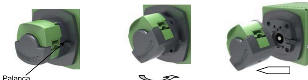
Ofrezca el nuevo cabezal a la palca posterior en un ángulo que ubique el eje del motor al rotor del eje dentro de la placa posterior en aproximadamente 45°, encarando las agarraderas en el alojamiento.
